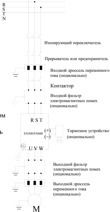
Рис.3-8 Соединение преобразователя и сопрягаемых деталей
